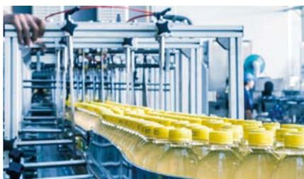
Подключив бесконтактный датчик к дискретному входу, можно собирать данные о количестве продукции.
